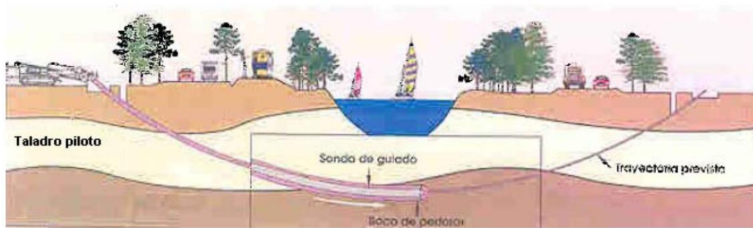
Figura 8: Detalle Perforación Piloto
