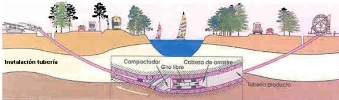
**Figura 10: Detalle Instalación de la Tubería**
