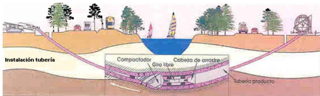
Figura 10: Detalle Instalación de la Tubería
