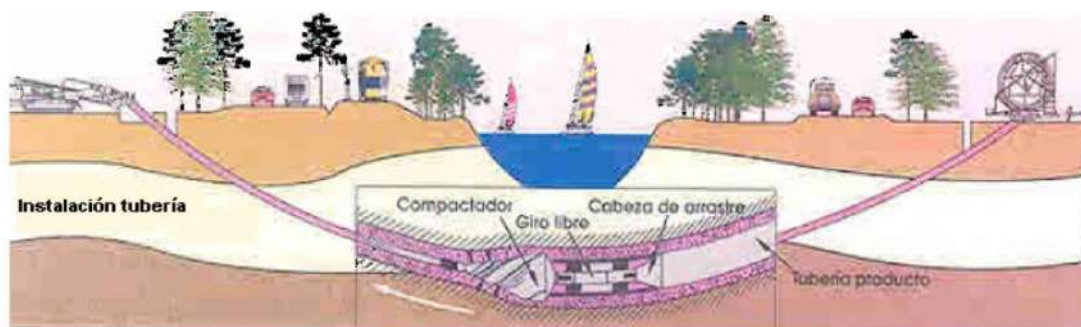
Figura 12: Detalle Instalación de la Tubería
